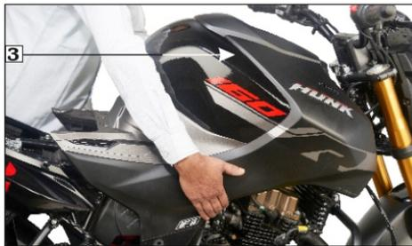
**(3) Cubierta del tanque de combustible**
