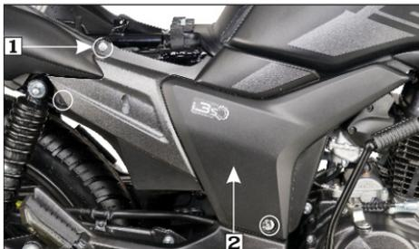
(1) Tornillos de la cubierta lateral derecha
