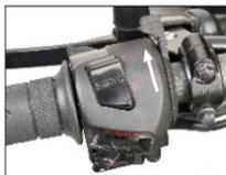
7. Empuje la palanca de arranque hacia arriba, a la posición
