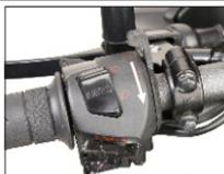
5. Tire de la palanca del choque hacia abajo como se indica (Use el choque en condiciones de frío)
