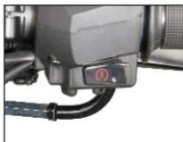
6. Presione el interruptor del arranque (Alternativamente, se puede usar el pedal de patada para arrancar).
