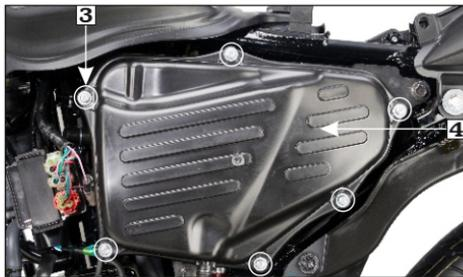
**(3) Tornillos/arandelas de la cubierta del filtro de aire**    **(4) Cubierta**
