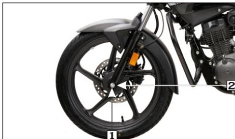
(1) Tuerca del eje (2) Sensor de velocidad
