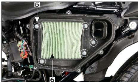
**(5) Tornillos/arandelas del filtro de aire del elemento**    **(6) Elemento filtro de aire**
