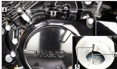
(4) Tapa del orificio del temporizador (5) Marca "T" (Tiempo) (6) Marca de referencia
