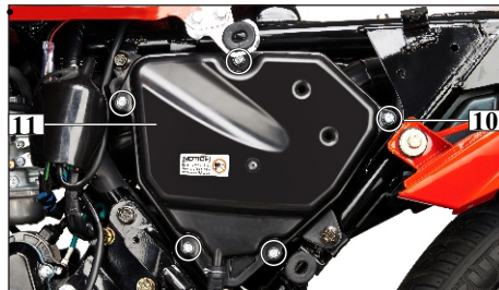
(10) Tornillos de la cubierta del limpiador de aire (11) Cubierta del limpiador de aire
