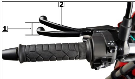
(1) Movimiento 10-20 mm (2) Palanca de embrague
