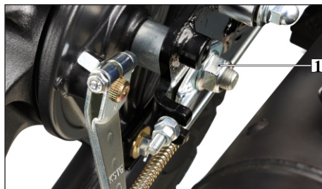
(1) Tuerca del eje posterior
