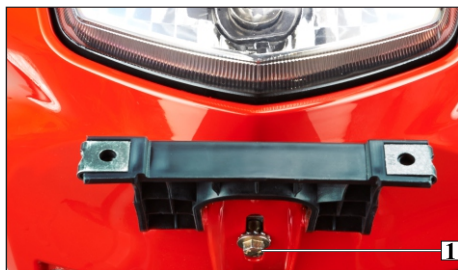
(1) Perno de ajuste de la farola
