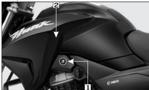
(1) Tornillos cubierta lateral izquierda
