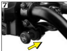
7 Empuje la palanca de arranque hacia adentro, ("OFF") como se indica, después de que el motor se haya calentado suficientemente para tener una respuesta estable del acelerador.
