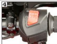
4 Asegúrese de que el interruptor de parada del motor esté en la posición "ON" (Ⓞ).
