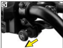
5 Tire de la palanca de arranque hacia abajo como se indica (Use la palanca de arranque en condiciones de frío)
